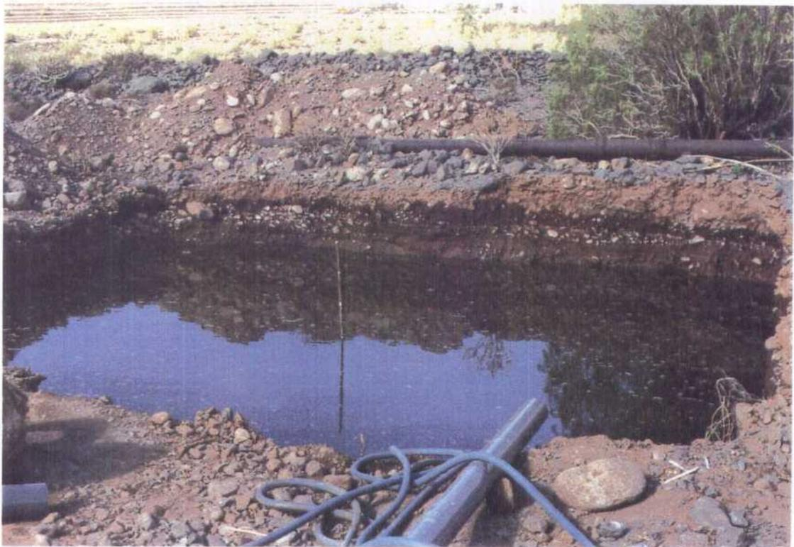
FOTO 5.2.16 y 5.2.17.- Ensayo de recarga en balsa. Vista del tan- que evaporimétrico y balsa al alcanzar la carga de 0,75 m en la balsa durante el en- sayo de vaciado.
