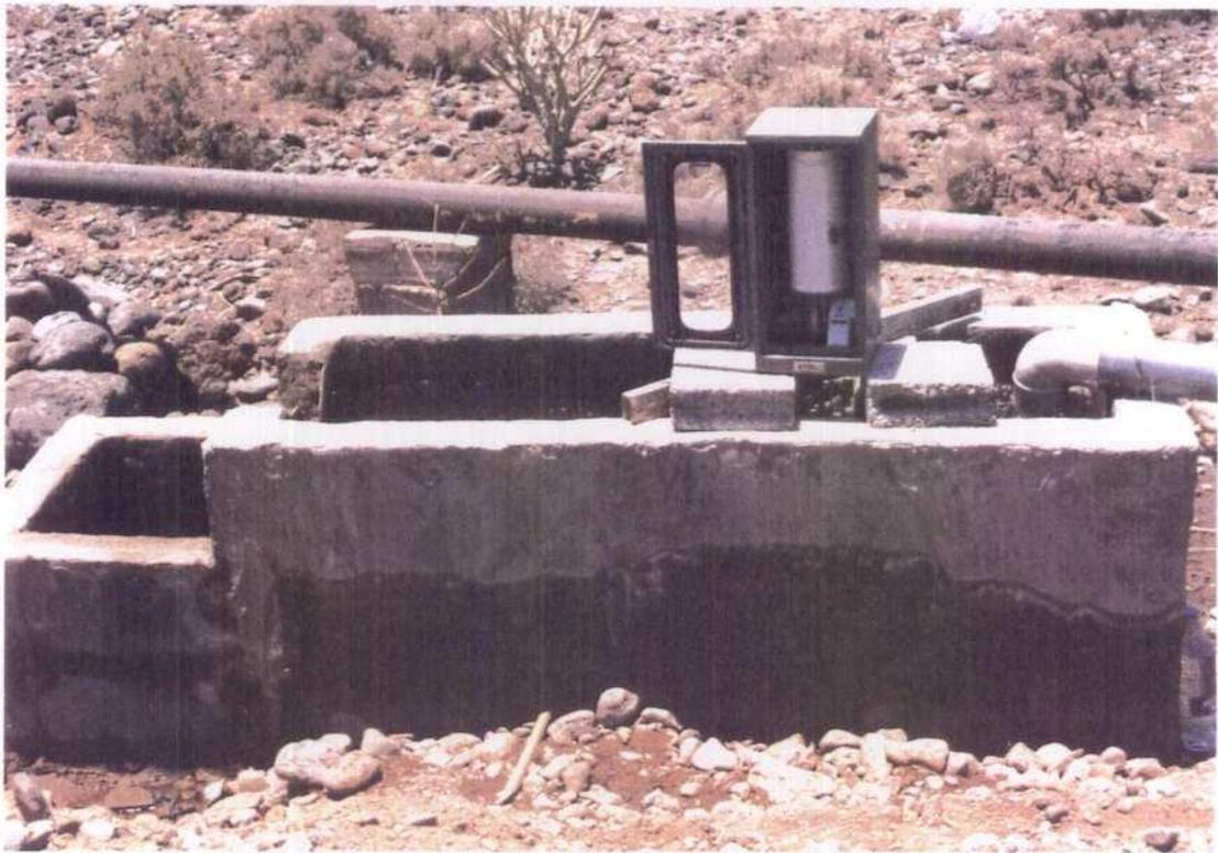
FOTO 5.2.12.- Ensayo de recarga en balsa. Detalle del limnigrafo.
