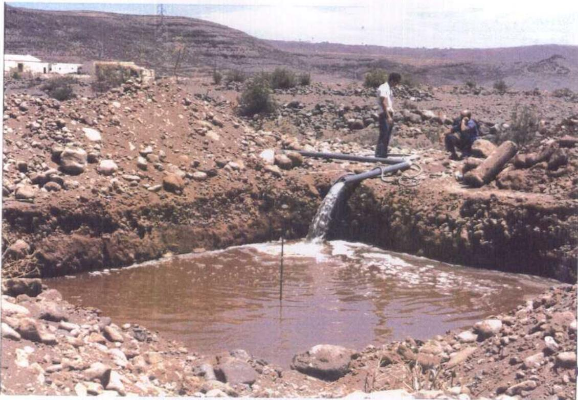
FOTO 5.2.14.- Ensayo de recarga en balsa. Vista de la balsa durante el llenado. Día 6/7/87.
