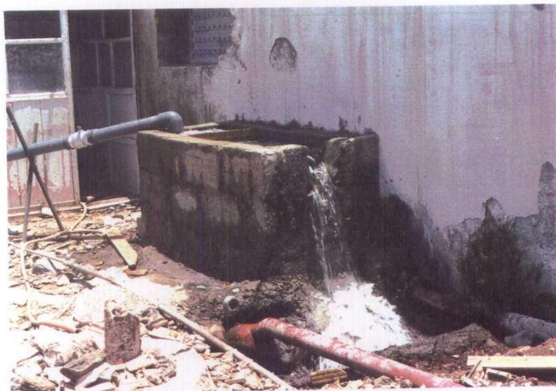
FOTO 5.3.4.- Ensayo de recarga en pozo. Tubería y válvula de alimentación, vertedero y sumidero de entrada a la tubería de inyección.
