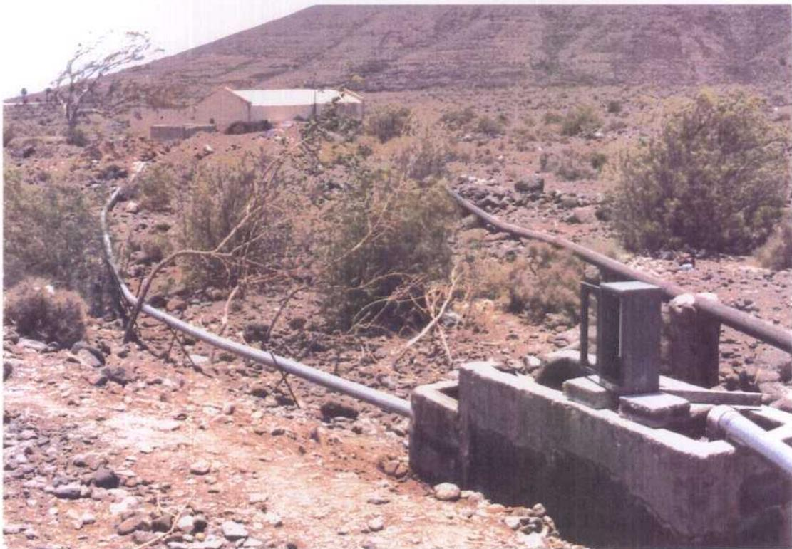
FOTO 5.2.13.- Ensayo de recarga en balsa. Conducción desde el vertedero hasta la balsa. A la dcha. tubería de suministro y al fondo caseta del pozo 424330028.
